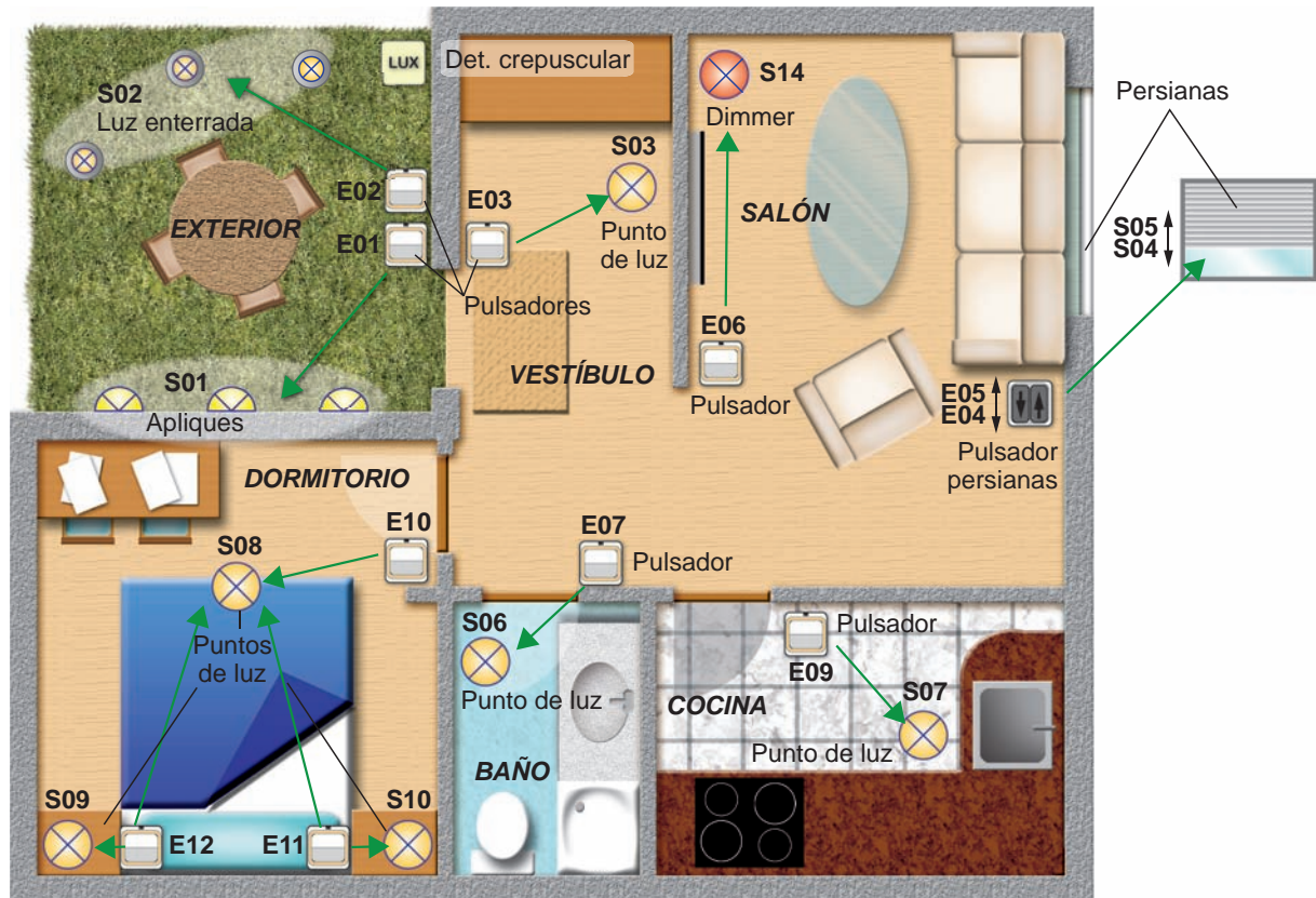
Fig. 10.34. Croquis de la instalación.
